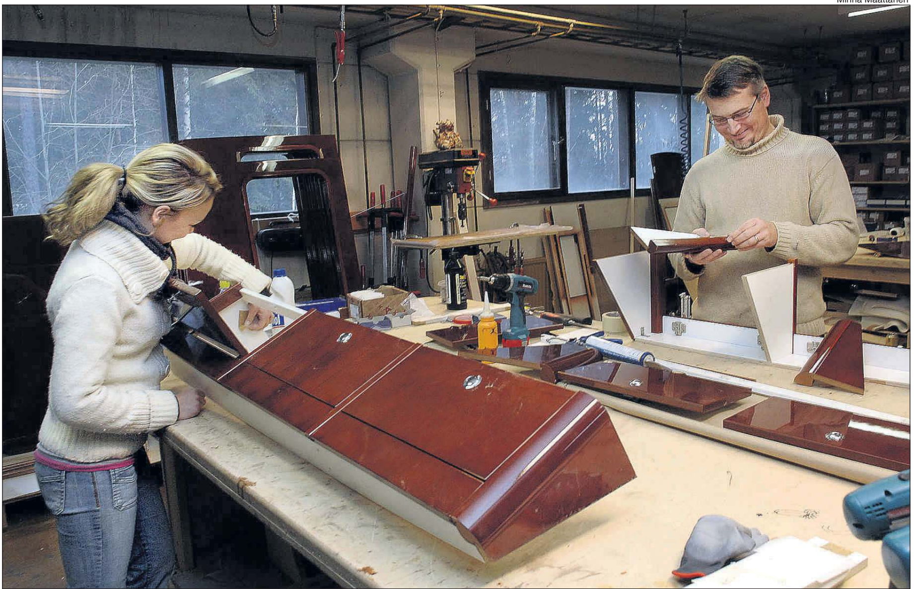
Emmi Laine ja Peter Sohlström kasaavat RMJ Saksmanille korjattaviksi tulleita kirsikkaviilusta valmistettuja veneiden keulakaappeja.
